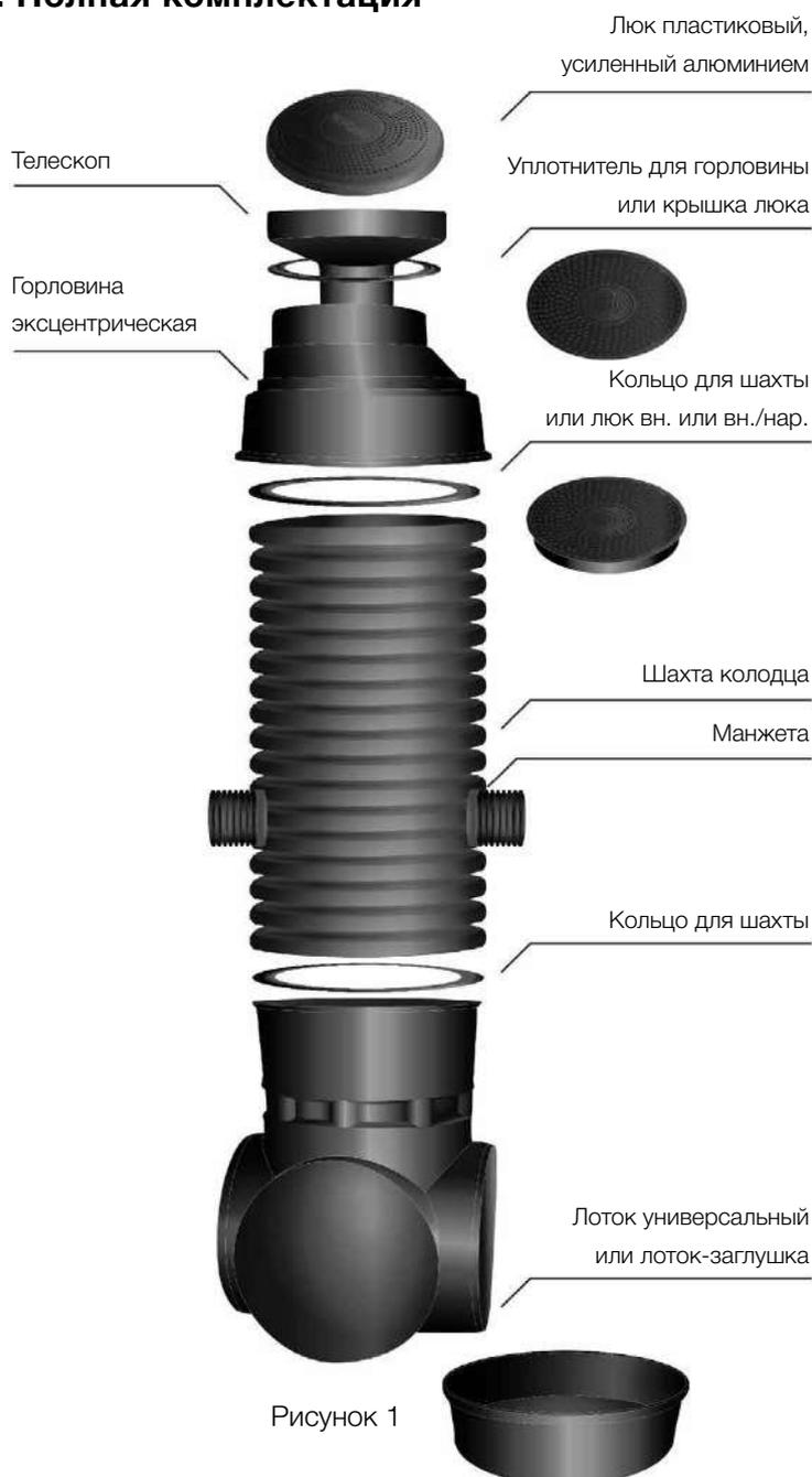
Для обеспечения полной герметичности колодца используются уплотнители для горловины эксцентрической, уплотнительные кольца для шахты, резиновые уплотнители. В зависимости от условий эксплуатации системы используются разные комплектации сборного колодца: без использования горловины эксцентрической (рис. 2, 3, 4), без телескопа (рис. 3, 5, 6).
