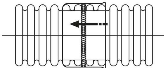
Рисунок 11. Схема соединения труб с помощью уплотнительного кольца
