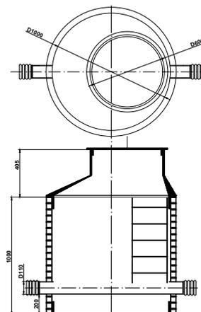
Типовой канализационный колодец FD SVT лотковый прямопроходной
